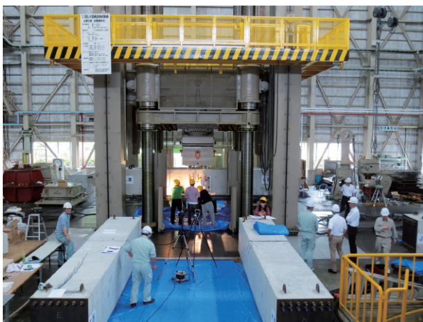
写真-7 「あと施工せん断補強筋の効果確認実験」の様子
