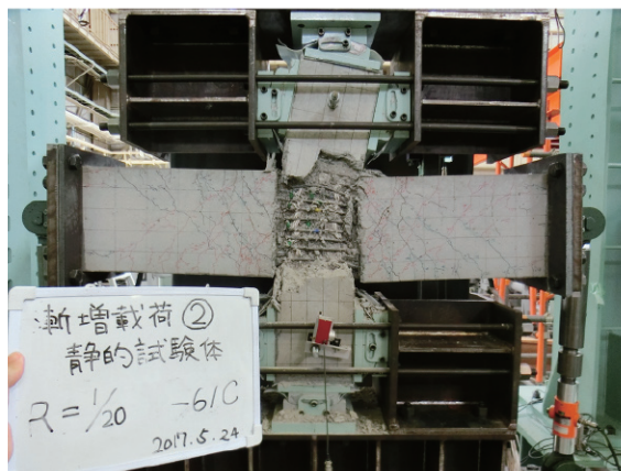
写真-4 修論「RC造柱梁接合部の実験」の様子
