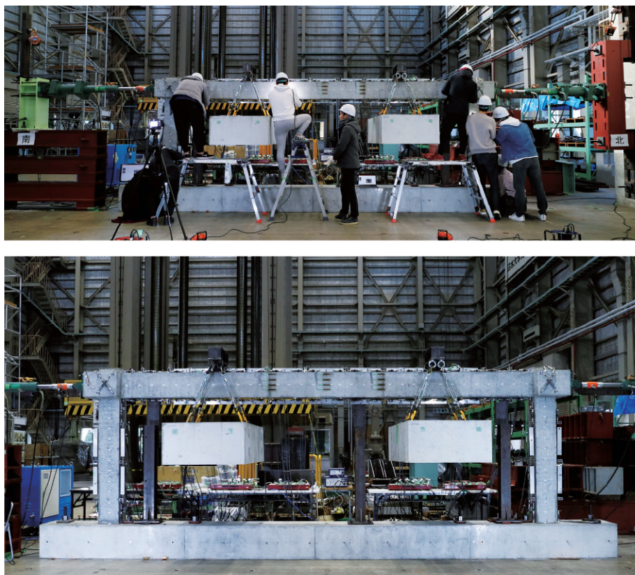
写真-5 修論「鉛直荷重下のPC架構の実験」の様子
