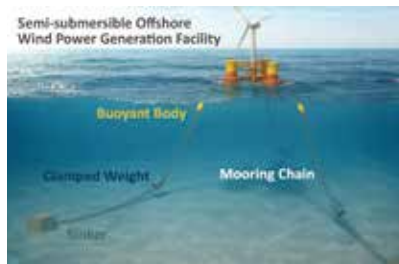
ブイやウエイトを付加した合理的な カテナリー係留設計
