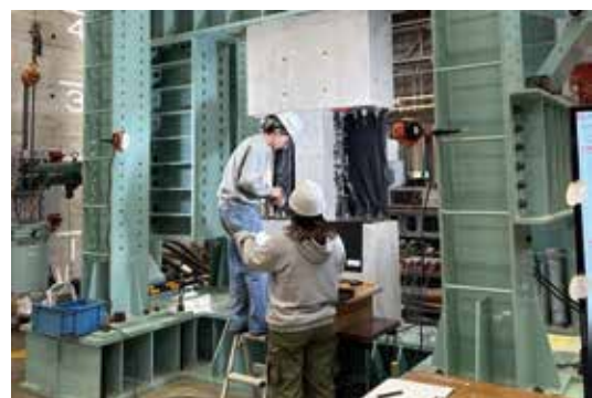
RC 部材のせん断実験（大型構造物試験棟）
