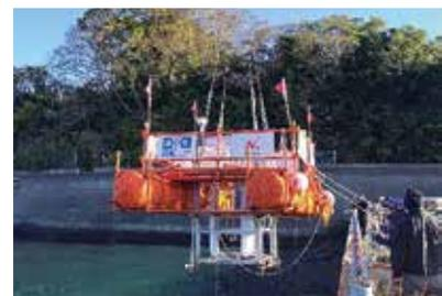
浮体式可変ピッチ VAMT の開発と実海域実験
