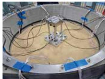
写真 5 杭基礎模型の実験状況
