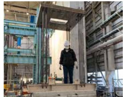
写真2 滑り基礎構造建物の振動台実験
