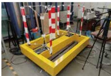
浮体式ツイン垂直軸型風車の開発
