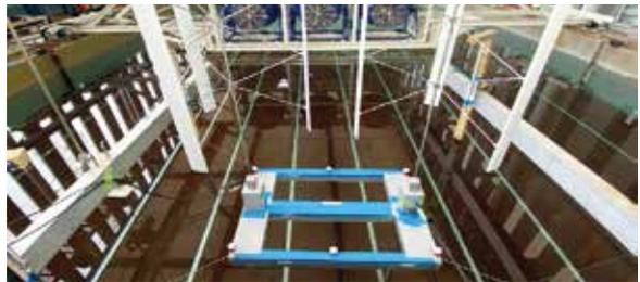
浮体式垂直軸型風車の実験模型
