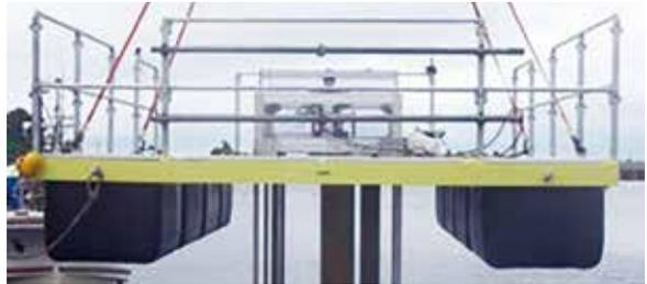
浮体式垂直軸型水車の実海域実験
