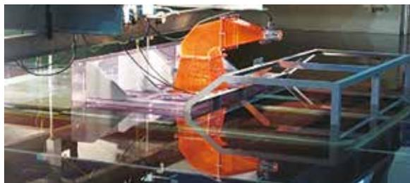
振動水柱型波力発電装置の水槽実験
