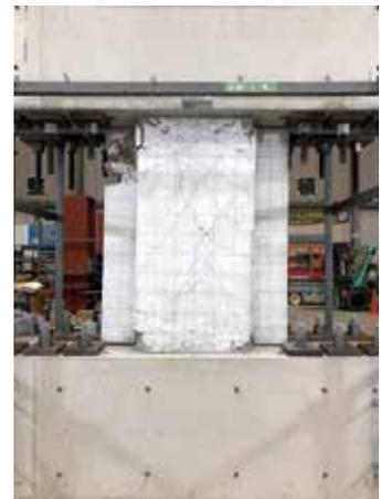
袖壁付き柱の構造実験
