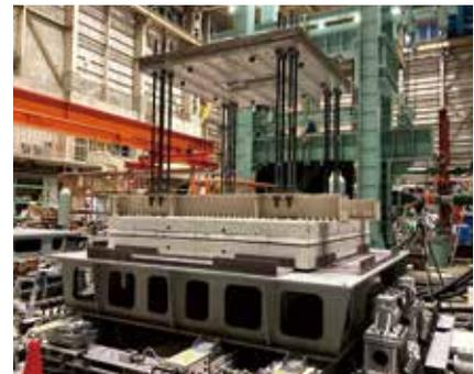
写真2 滑り基礎構造建造物の振動台実験
