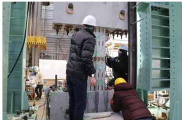
写真 1 PC 梁のせん断破壊実験準備
