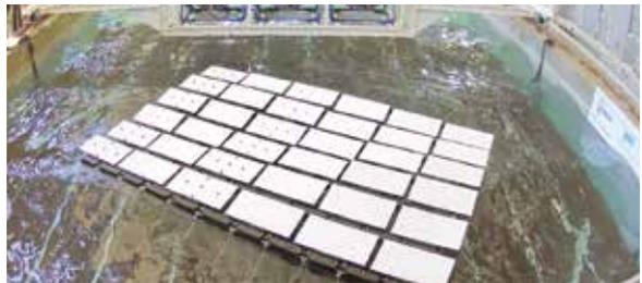
浮体式太陽光発電施設の水槽実験
