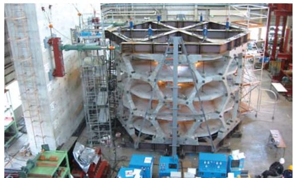
大型構造物試験センターで実施した PC ハニカム構造の実験
