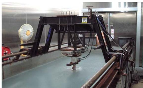
低温実験室における氷海構造物の実験
