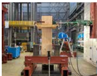
写真 4 木造新構法の梁の実験状況
