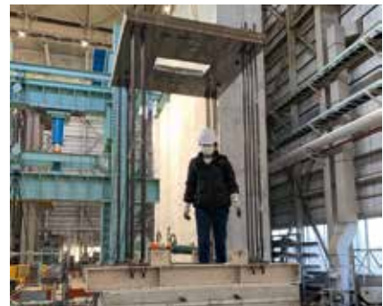
写真2 滑り基礎構造建物の振動台実験
