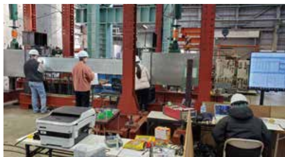
写真 1 PC 梁の載荷試験
