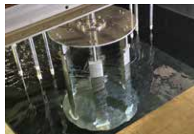
垂直軸水車の流体力特性の水槽実験
