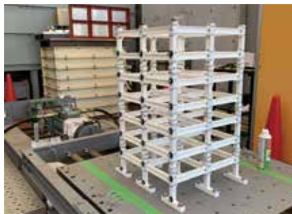
写真3 3Dプリンターで製作した試験体の構造実験
