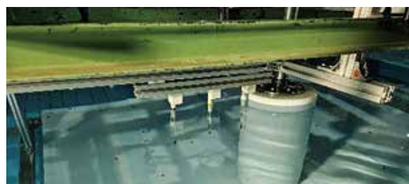
大水深掘削技術に関わる回転円柱の水槽実験
