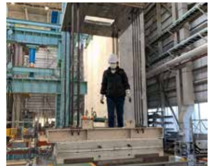
写真2 滑り基礎構造建造物の振動台実験
