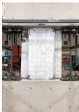
写真2 袖壁付き柱の構造実験
