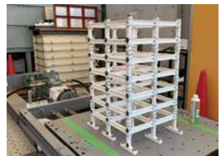
写真4 3Dプリンターで製作した試験体の構造実験
