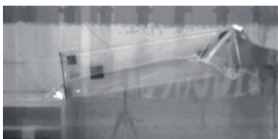
粒子法による浮体乗り上げシミュレーションと実験の比較
