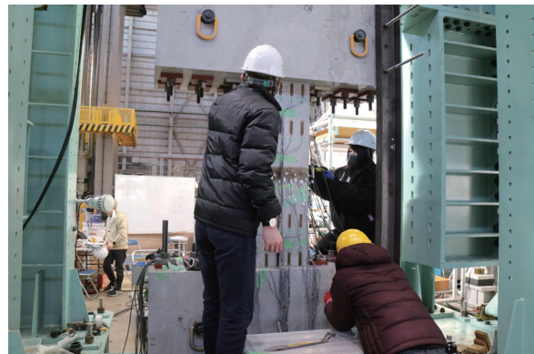
写真1 PC梁のせん断破壊実験準備
