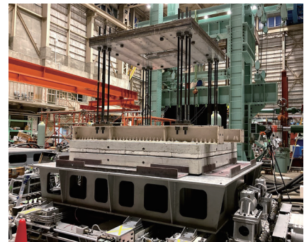
写真2 滑り基礎構造建物の振動台実験
