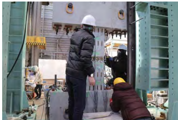
写真1 PC梁のせん断破壊実験準備
