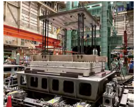
写真2 滑り基礎構造建物の振動台実験
