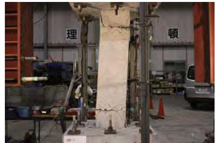
プレキャスト部材の構造実験
