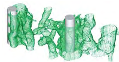
卒業研究より：直列2円柱の背後での渦の流れの様子
