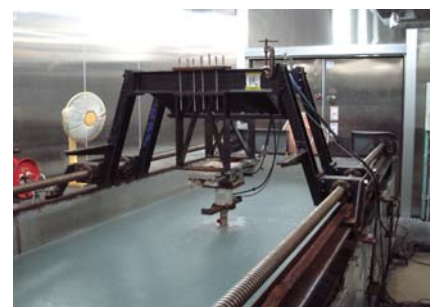
写真4 低温実験室における氷海構造物の実験
