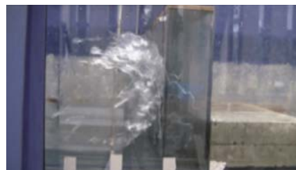
建築物に作用する津波衝撃波圧に関する実験
