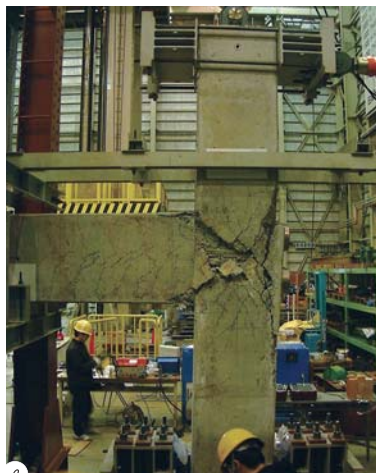
実大 PC 造柱梁接合部破壊実験
