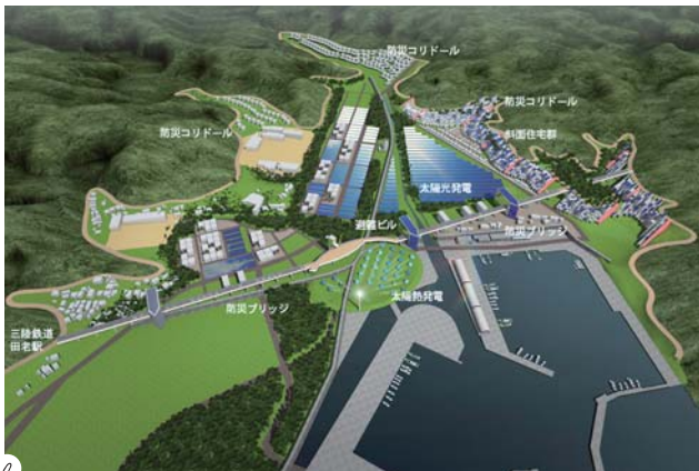
「東日本大震災復興都市モデル」田老地区全体計画の図。河口近くの避難ビルと防災ブリッジにより垂直と横移動ができる。住宅群は斜面に設置。中央に地域創生のためのメガソーラ施設を設置。
