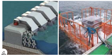
潮流発電装置(左)と波力発電装置(右)の実海域実験
