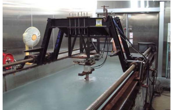
低温実験室における氷海構造物の実験
