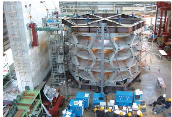
大型構造物試験センターで実施した PC ハニカム構造の実験
