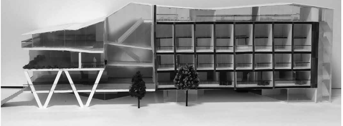
集合住宅とシェアオフィス、販売ブースのある複合型住宅。シェアオフィスと集合住宅を切り離したのはONとOFFを切り替える必要があると考えたため。一方で、全体的に一体感を出すために全体を大屋根で囲んだ。
